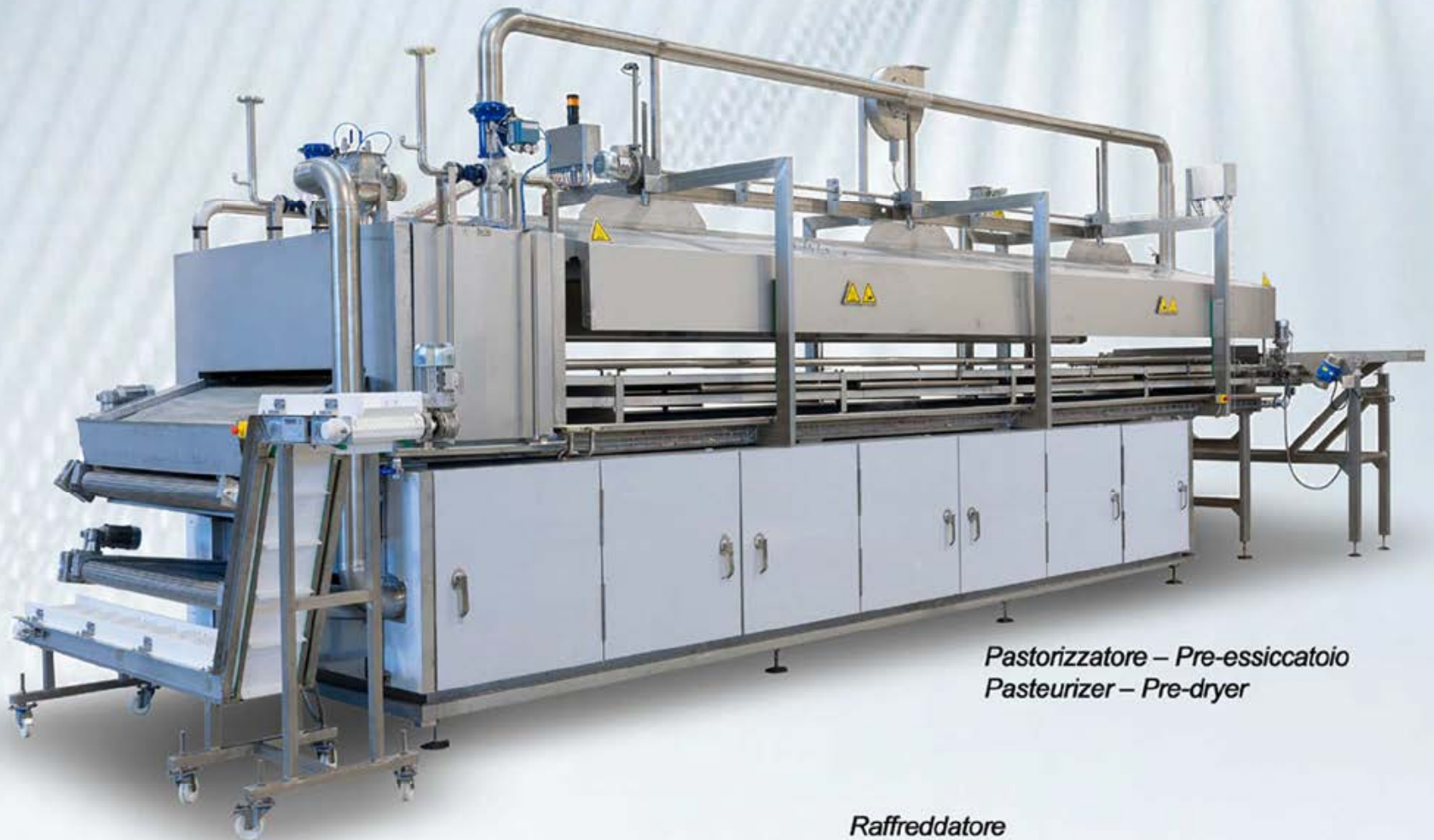
Pastorizzatore con zona di asciugatura Pasteurizer with drying area
