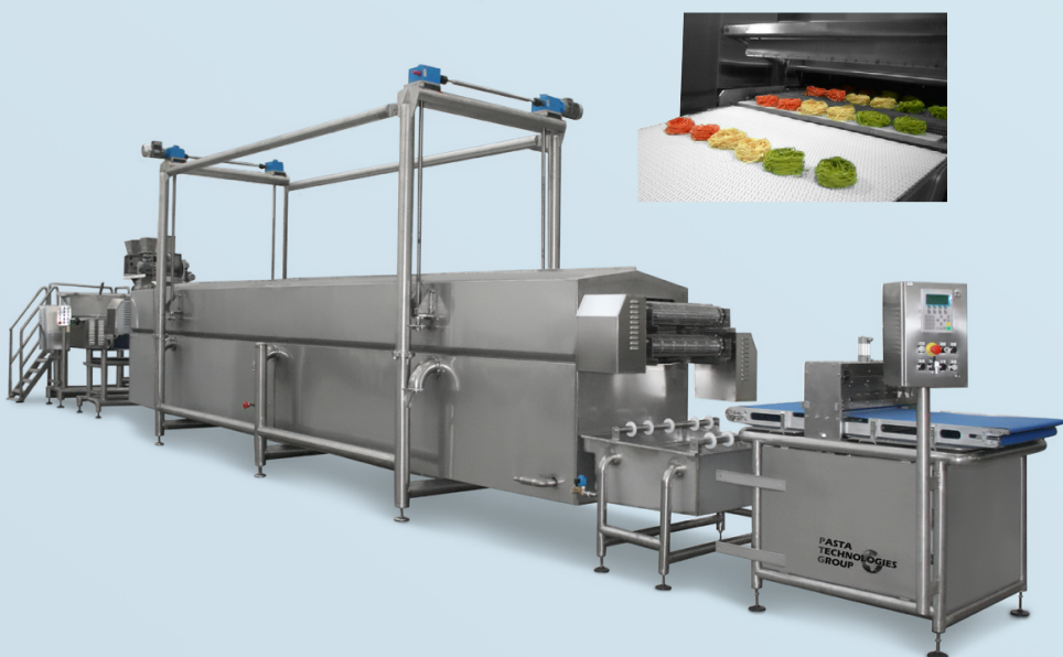
Linea pre-cottura lasagne, capacità 800 kg/h
