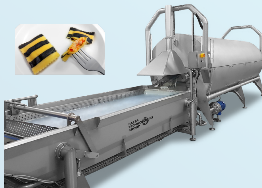
Linea pre-cottura per ravioli, capacità 3000 kg/h
