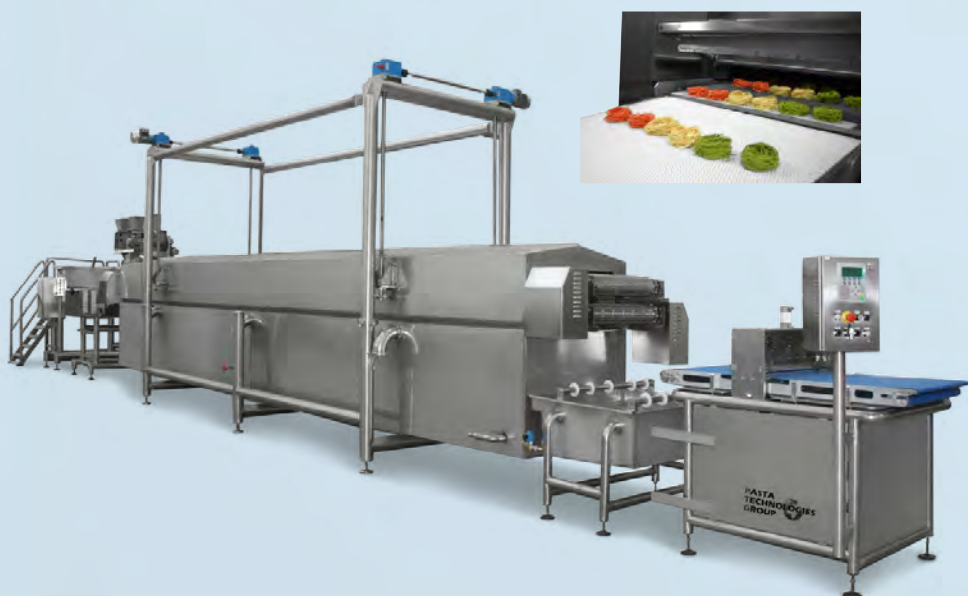
Linea pre-cottura lasagne, capacità 800 kg/h
