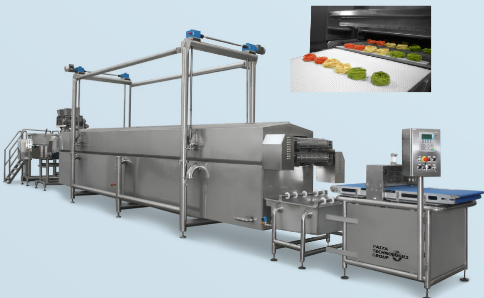
Linea pre-cottura lasagne, capacità 800 kg/h
