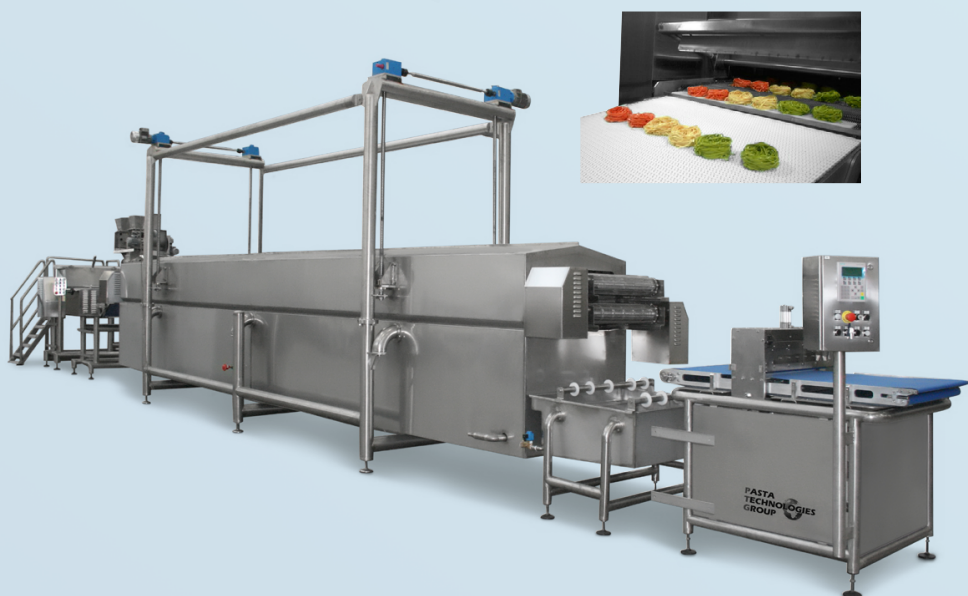
Linea pre-cottura lasagne, capacità 800 kg/h
