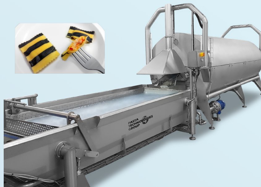
Linea pre-cottura per ravioli, capacità 3000 kg/h
