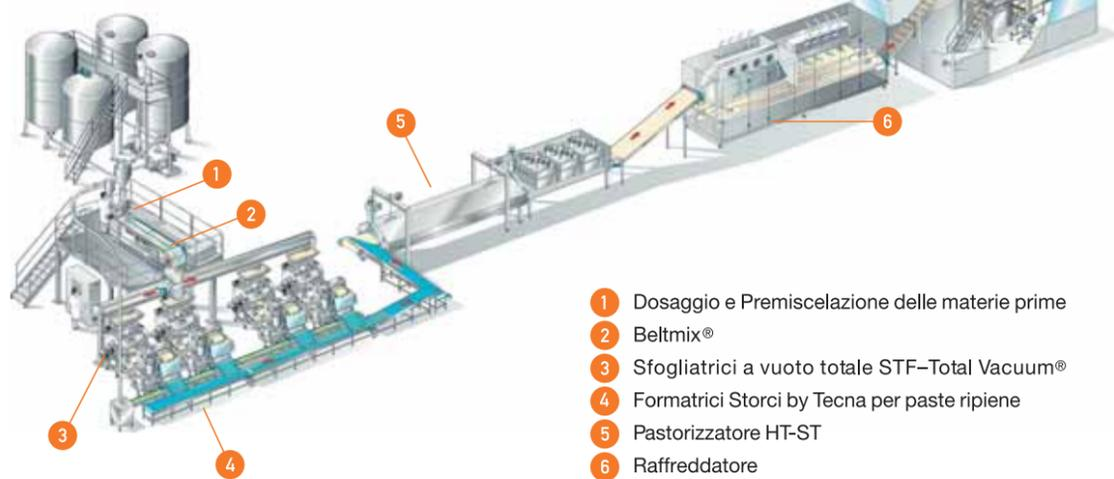
Il processo di produzione delle paste fresche è considerato da molti acquisito da tempo. Noi proponiamo importanti e significative innovazioni per ogni fase tecnologica del processo di produzione della pasta fresca: dosaggio e premiscelazione delle materie prime, impasto, formazione del prodotto, recupero sfridi, pastorizzazione, asciugatura e raffreddamento.
