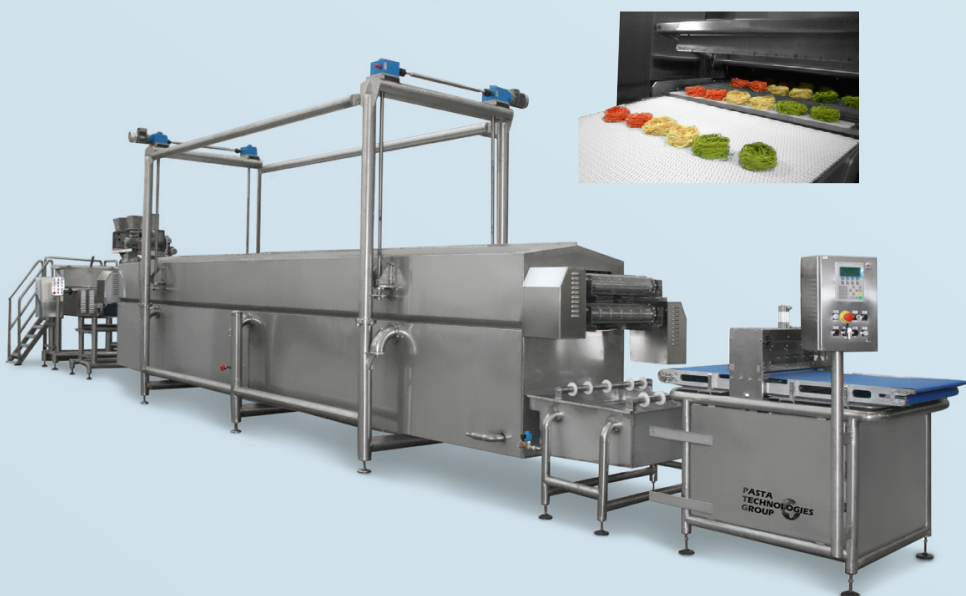
Linea pre-cottura lasagne, capacità 800 kg/h
