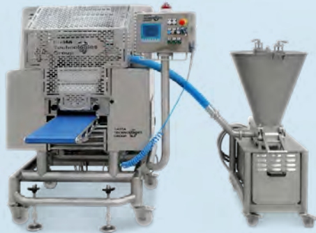
FORMATRICE RAVIOLI MOD. FJS300 PER FORMATI JUMBO CON POMPA A LOBI PER RIPIENI CREMOSI. Disponibile in vari modelli.
