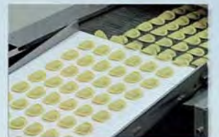
Pastorizzatore pre-essiccatore Pasteurizer pre-dryer
