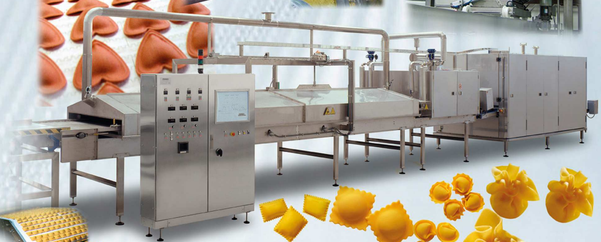
LINEA PASTE FRESCHE RIPIENE (150-1500 kg/h) FRESH FILLED PASTA LINE
