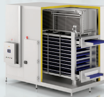
TUNNEL "D" in caduta
