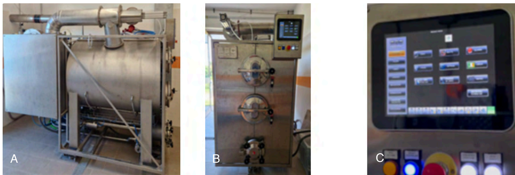
Figura 2 IMMAGINI DELL'IMPIANTO MALTATORE PILOTA UTILIZZATO: (A) VISTA LATERALE, (B) VISTA FRONTALE, (C) QUADRO DI CONTROLLO
