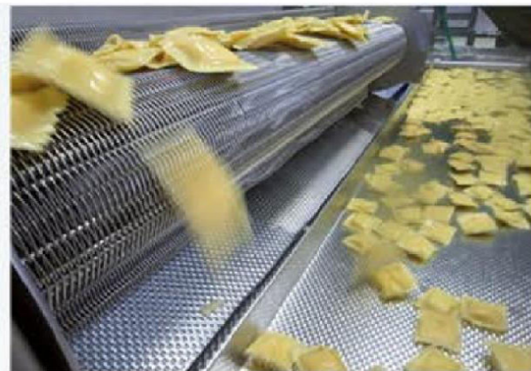
Scarico su piano vibrante Vibrating feeder
