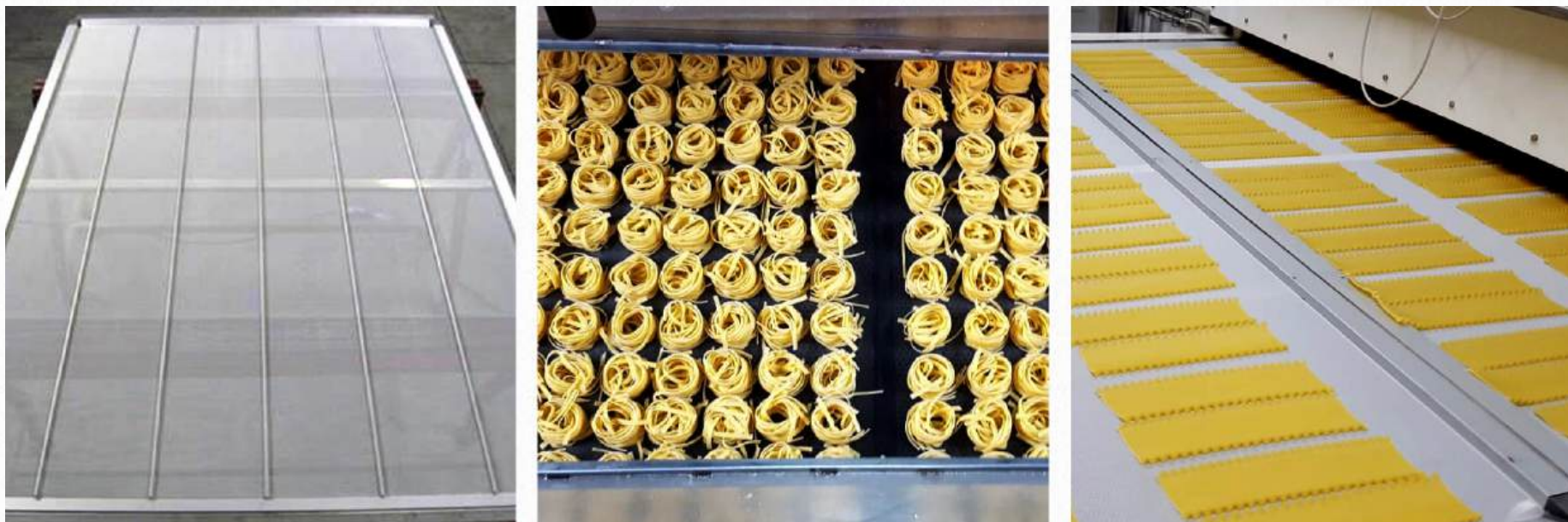
Figura 3 TELAI LISTELLATI ADATTABILI AL CONFEZIONAMENTO DEI DIVERSI FORMATI
