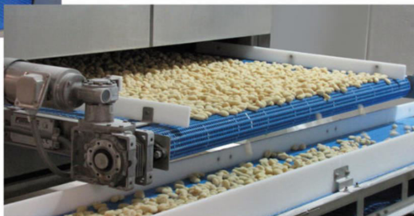
Uscita raffreddatore Cooler outlet
