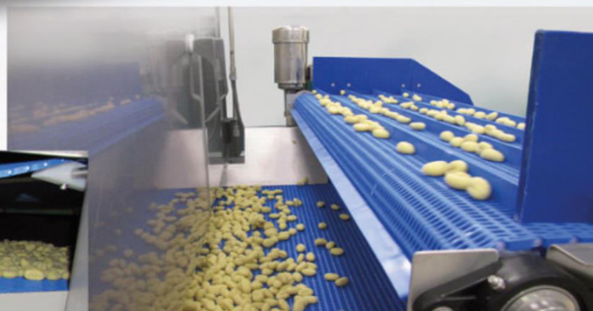
Entrata raffreddatore Cooler inlet
