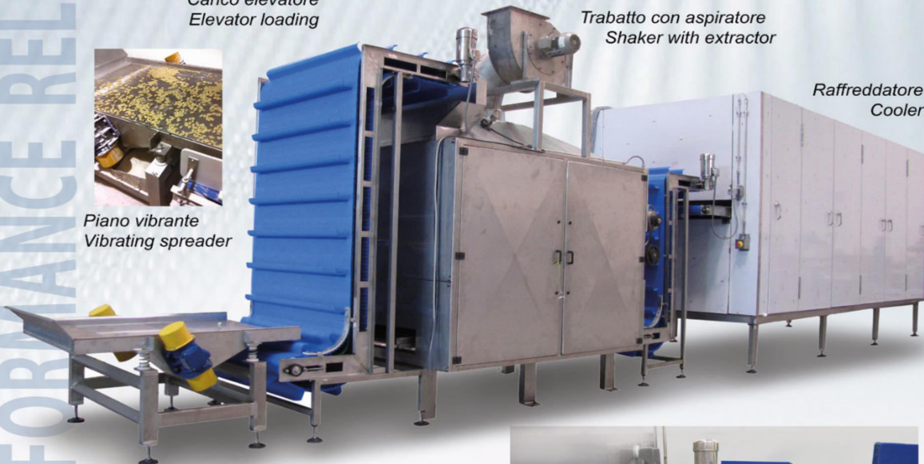
Entrata raffreddatore Cooler inlet
