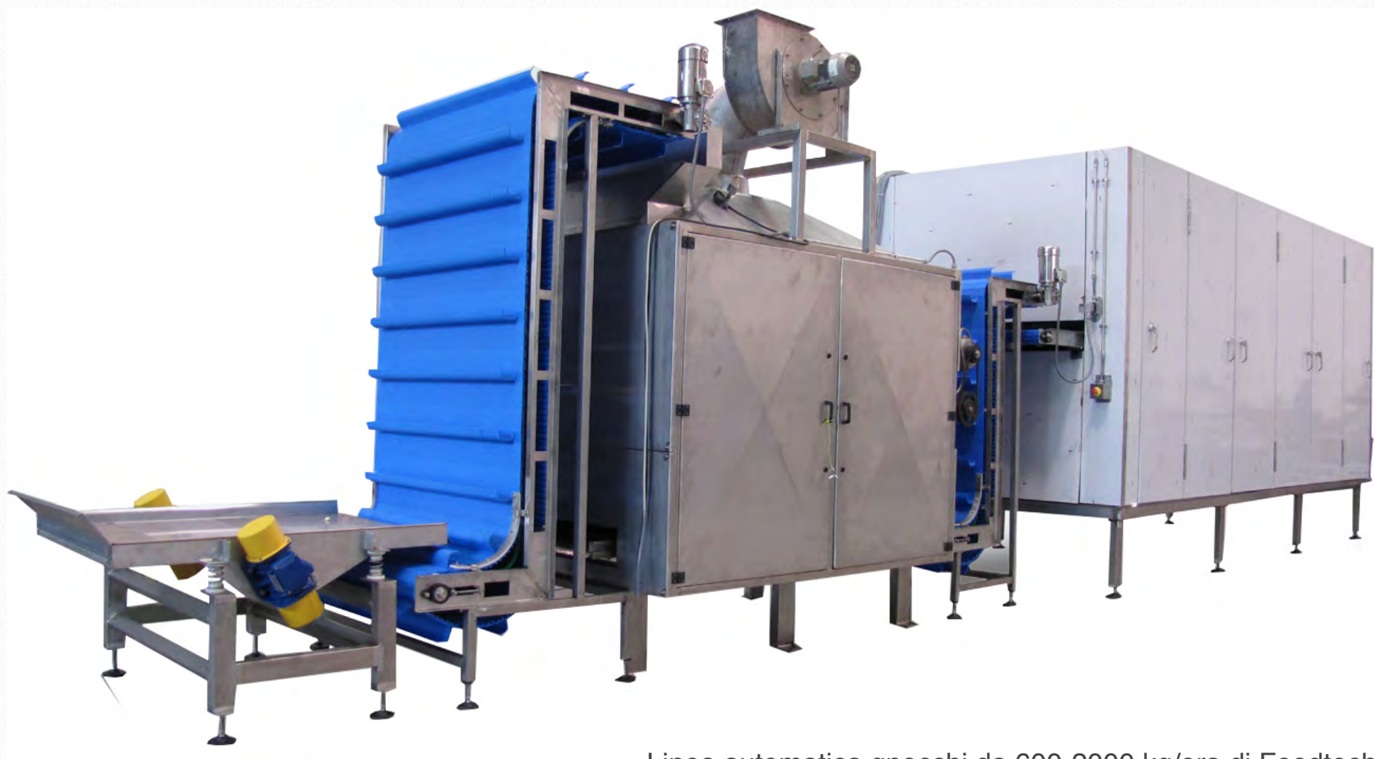
Linea automatica gnocchi da 600-2000 kg/ora di Foodtech
